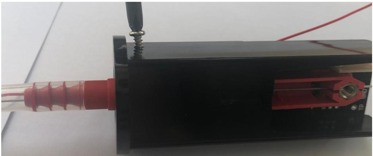
信号板推到底部，将两个 M2.5\*5 螺钉拧入黑托架两侧小孔，固定信号板。
