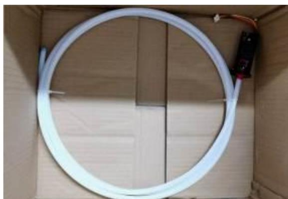
装配到步骤 4 可以卷成直径 35cm 以上的圆盘发货。
