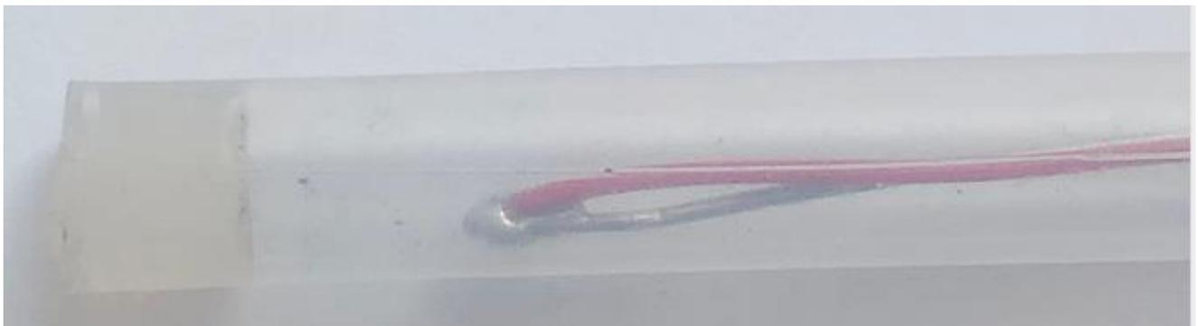
把焊接好返回线的波导丝插入铁氟龙（PTFE）管，**保留波导丝与高温线底端焊接点到管底部橡胶约1CM余量，不要触碰到管底部（安装过程中要保持）。**
