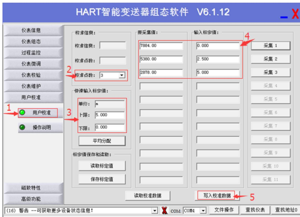
图 3：菜单‘用户校准’ ->选择‘校准点数’ ->设置上下限->平均分配或者手动输入标定值->采集对应数值->‘写入校准数据’。
