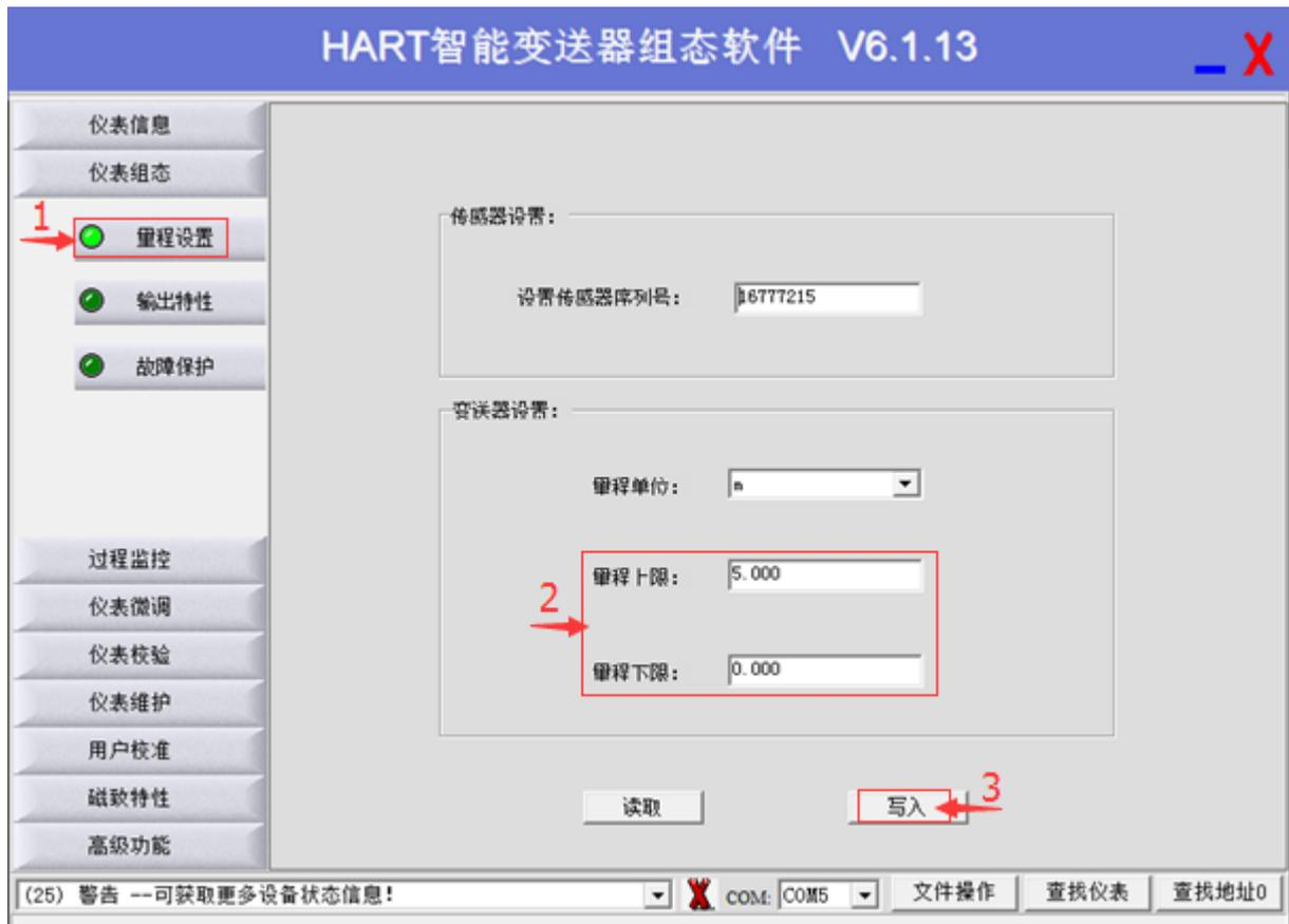
图 4: 仪表组态 ->量程设置->设置 量程上下限。
