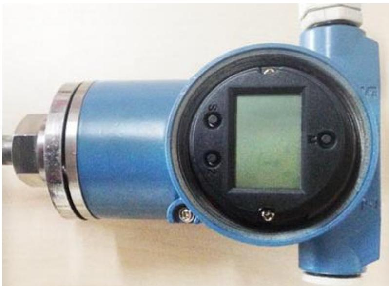
上紧探杆固定螺钉，完成磁致伸缩液位计整体装配。装配大功告成！
