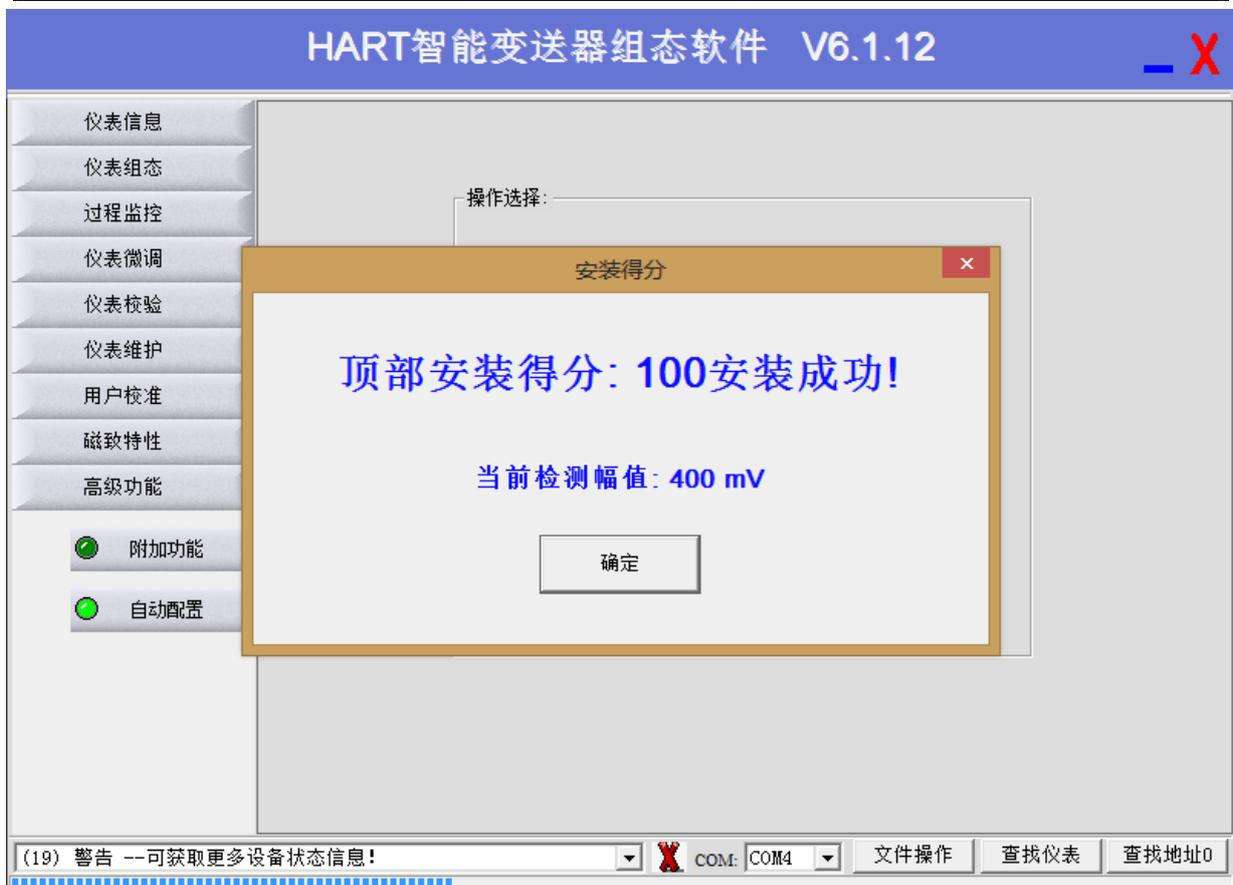
图 1、2：打开 HART 组态软件，查找地址 0->选择‘高级功能’->‘自动
