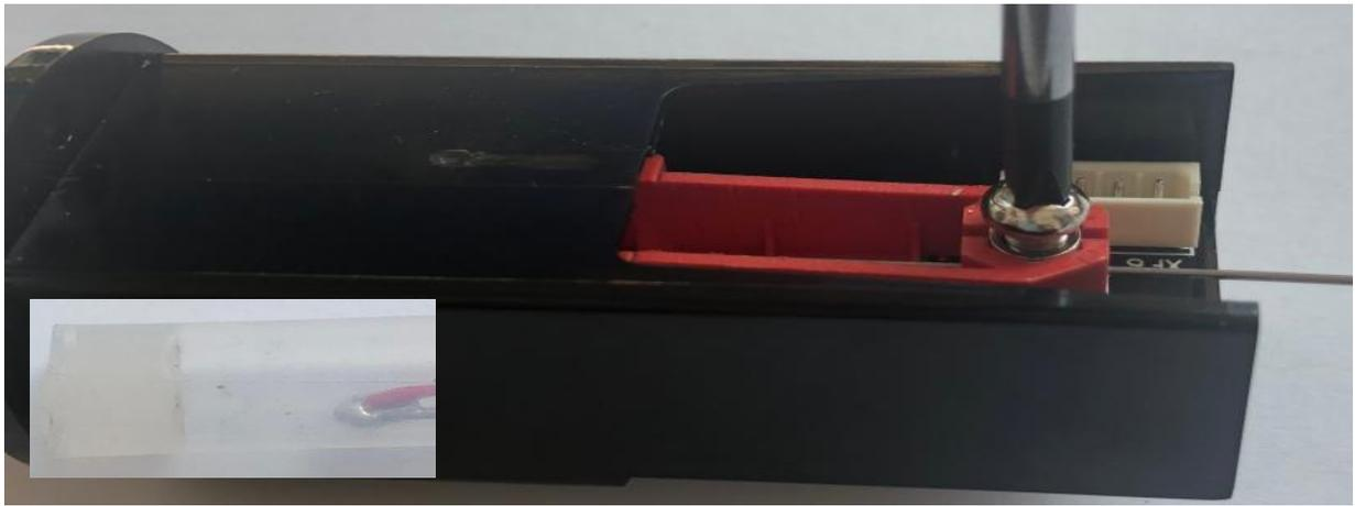
用适当力度拧紧 M4\*5 的螺钉，固定波导丝（注意先检查 波导丝和返回线焊点，此时距离底部橡胶的 1CM 距离！见上图左下角小图示意。）
