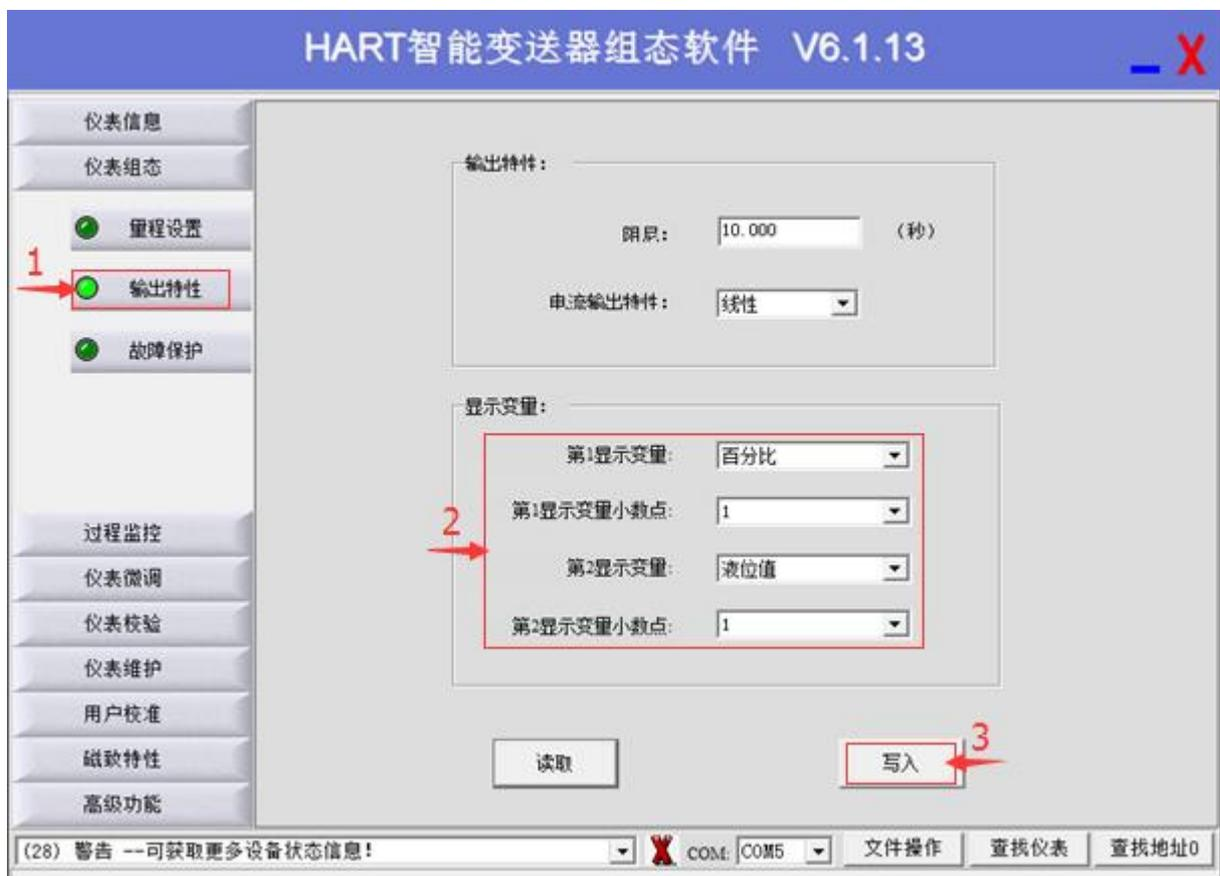
图 5: 仪表组态 ->输出特性->设置 显示变量及小数点位数。
