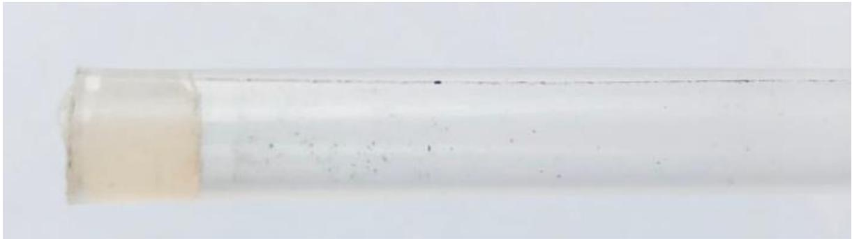
将白色橡胶条取1CM左右塞入铁氟龙（PTFE）管一端，塞入大于一半以上，用壁纸刀将多余的橡胶条去掉（与PTFE管平齐）；防止波导丝和不锈钢管短路，也可防止金属管壁凝露的水或潮气进入铁氟龙（PTFE）管内。
